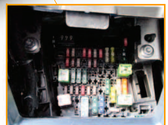
Relais- und Sicherungshalter SC im Fahrgastraum unten links, hinter dem Ablagefach
