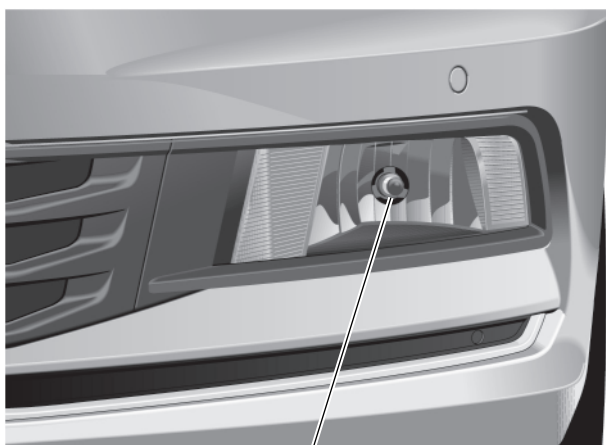
Nebelscheinwerfer/statisches Kurvenlicht H11 55W
